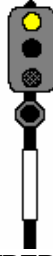
Fig. 33. LIBER cu viteza stabilită. ATENȚIE! Semnalul următor ordonă oprirea -primul sector de bloc din față este liber, dar al doilea este ocupat.
