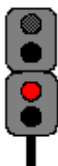
Fig. 45. Trierea oprită! Ziua și noaptea - o unitate luminoasă de culoare roșie, spre locomotivă
