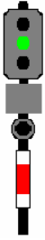
Fig. 74. Liber cu viteza stabilită. Semnalul următor este pe liber cu viteza stabilită.
