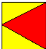
Fig. 139. Indicatorul "semnalul este pe partea stângă a căii".
