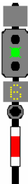
Fig. 61. Libera cu viteză stabilită. Semnalul următor indică liber cu viteză redusă indicată – prin cifrele 2, 3, 6, 8, 9 sau 10 - prevestită de către indicatorul luminos prevestitor de viteză. În figură, cifra 6 înseamnă 60 km/h.
