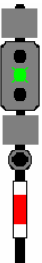
Fig. 57. Liber cu viteza stabilită. Semnalul următor indică liber cu viteza stabilită. Semnalul care urmează după semnalul următor ordonă oprirea. Indicația apare numai în stațiile situate pe o secție înzestrată cu bloc de linie automat cu patru indicații.
