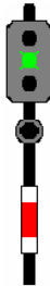
Fig. 65. Liber cu viteza stabilită. Semnalul următor indică liber cu viteza stabilită. Semnalul care urmează după semnalul următor ordonă oprirea. Indicația apare numai dacă ieșirea se face către blocul de linie automat cu patru indicații.
