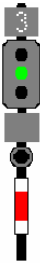
Fig. 59. Libera cu viteză redusă afișată de indicatorul luminos de viteză – prin cifrele 2, 3, 6, 8, 9 sau 10. În figură, cifra 3 înseamnă 30 km/h. Semnalul următor este pe liber cu viteză egală sau mai mare.
