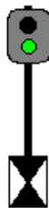
Fig. 38. LIBER cu viteza stabilită! Semnalul următor este pe liber cu viteza stabilită.
