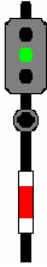
Fig. 63. Liber cu viteza stabilită. Semnalul următor este pe liber cu viteza stabilită.
