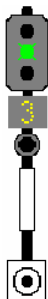
Fig. 96. Liber cu viteza stabilită, semnalul următor este pe liber cu viteza prevestită de către indicatorul luminos prevestitor de viteză.
