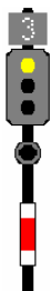
Fig. 72. Liber cu viteza redusă afișată de indicatorul luminos de viteză – prin cifrele 3, 6, 8, 9 sau 10. În figură, cifra 3 înseamnă 30 km/h. ATENȚIE! semnalul următor ordonă oprirea.
