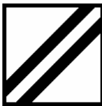
Fig. 146. Atenție, halta comercială sau punctul de oprire în linie curentă este la 1000 m!
