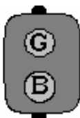
Fig. 226. Semnalul luminos de ieșire este pe oprire. Ziuă și noaptea - inițialele stațiilor, neiluminate, unde este posibilă împingerea garniturii trenului.
