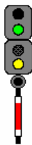
Fig. 30. LIBER cu viteza redusă. Semnalul următor este pe liber cu viteza stabilită sau redusă.
