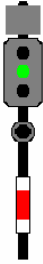
Fig. 67. Liber cu viteza stabilită. Semnalul următor este pe liber cu viteza stabilită.
