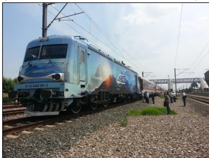
Figura 5,3 - Trenul Bucuresti - Sarulesti care a efectuate teste de franare la viteze de 160 km/h pentru introducerea trenurilor cu viteză sporită în regim comercial Sursa: Ministerul Transporturilor
